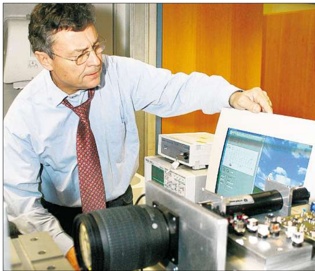
EXAKT MESSBAR sind die Auswirkungen von Vibrationen auf Faserkreisel. Zum Einsatz kommt dabei das Laservibrometer, hier bedient von Friedemann Mohr. Foto: Klaus Müller
